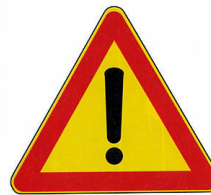
Figura II 388 Art. 31 Mezzi di lavoro in azione Presegna un pericolo costituito dalla presenza di macchine operatrici, pale meccaniche, escavatori, uscite di autocarri, etc. che possono interferire con il traffico ordinario in presenza di un cantiere stradale.
