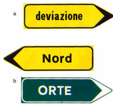
Figura II 407 Art. 43 Segnali di direzione Il segnale a) ha funzione di conferma della deviazione prevista dal segnale di Fig. II 405 per deviazioni di limitata lunghezza. Il gruppo segnalatico b) ha la funzione di conferma delle direzioni previste dal segnale di Fig. II 406. Il colore di fondo del segnale in basso è quello caratteristico del tipo di uscita.
