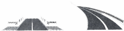
Figura II 471 Art. 175 Segni sugli ostacoli, anomalie e punti critici stradali. Gli ostacoli, le anomalie e i punti critici stradali, che comportano restringimento della carreggiata o pericolo per la circolazione, qualora non eliminabili, devono essere segnalati mediante strisce alternate nere e bianche inclinate a 45° in basso verso il lato di transito dei veicoli.
