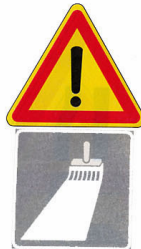
Figura II 391 Art. 31 Segni orizzontali in rifacimento Presegna un pericolo dovuto alla temporanea mancanza della segnaletica orizzontale, ovvero lavori di tracciamento in corso sul tronco stradale della lunghezza indicata dal pannello integrativo modello II 2 abbinato.
