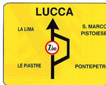
Figura II 408 Art. 39 Preavviso di deviazione Esemplifica una limitazione di transito lungo un tronco di strada, vietandolo ai veicoli aventi una massa totale superiore a 7,0 t, ed indica l'itinerario alternativo percorribile da parte di tali veicoli.
