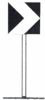
Figura II 468 Art. 174 Delimitatori modulari di curva. Sono installati in serie di più elementi lungo il lato esterno di curve stradali ed autostradali per migliorare la visibilità dell'andamento della strada a distanza.
