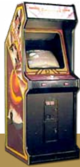
VIDEOSPIELGERÄT (1985) SCHWENKBARER MONITOR EINFACHER SPIELEWECHSEL DURCH EINSCHUB-SYSTEMLADE
