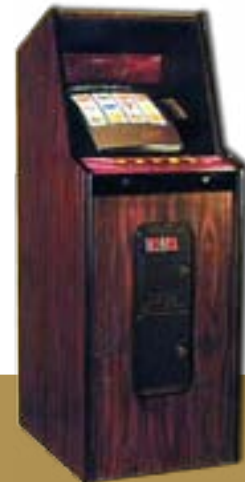
VIDEOSPIELGERÄT (1986) SCHWENKBARER MONITOR SPIELEWECHSEL DURCH PLATINENTAUSCH
