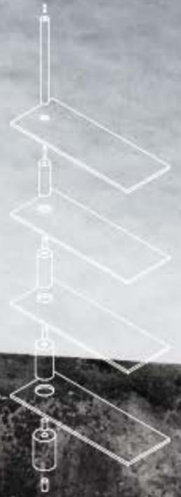
*il PERNO che sostiene le mensole dei posti letto è costituito da un sistema di cilindri di legno che si assemblano a secco: forati alle due estremità, si saldano tra loro mediante dei tasselli lignei, e vengono intervallati dalle assi di compensato di spessore 30mm.*
