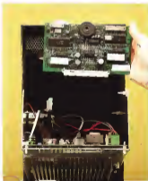
L'elettronica del MicroPower 700 è realizzata facendo uso di schede modulari. Nella foto si vede la scheda che collega la CPU per il controllo numerico delle grandezze fasiche e la CPU che sovrintende al funzionamento del pannello operativo. Al centro: da i due processori è visibile il segnalatore acustico che fornisce le indicazioni d'allarme relative al funzionamento del gruppo. Nella parte inferiore del gruppo si vede la generosa ventilazione del dissipatore. In basso: il blocco di potenza.
