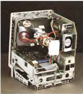
Il chip del Macintosh SE30 mostra come è nella foto. In alto a destra c'è il chip di ingegneria Apple. La motherboard piccola ma densa di componenti ospita il processore Motorola 68010, il processore 68012 ed il processore video per la base del cabinet. Sotto motherboard sono a vista le zone magnetici di memoria e del hard disk. La piccola ma efficace ventola prevede di assicurare la circolazione d'aria all'interno del computer.
