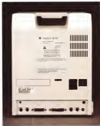
Il retro della macchina con nell'ordine da sinistra: le due prese dell'Apple design di porta IDE 232 per il collegamento del drive esterno, di porta SCSI e le due porte modeme complete. In fondo si vede la presa mouse; altro è, più in alto, e ancora un connettore di alimentazione, le prese per l'accesso al corrente stesso.
