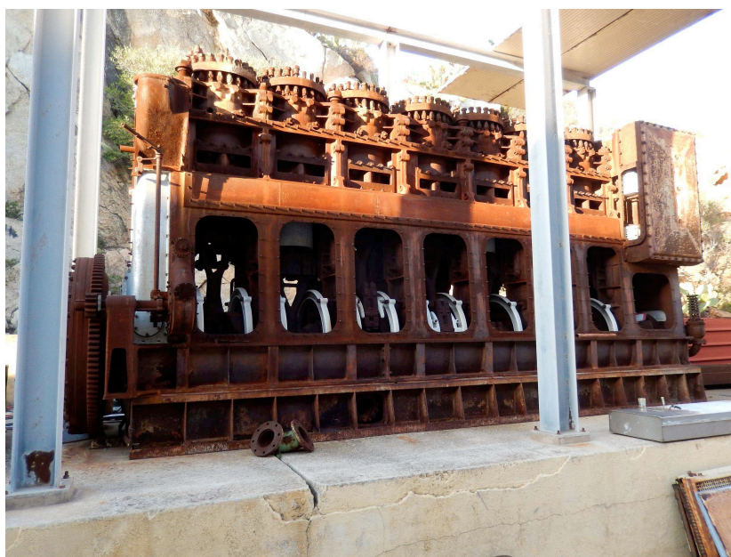
Fig. 161- Motore 407, vista laterale lato lavaggio, volano e comando, pompa aria a dr – Probabilmente l'ultimo esemplare rimasto, era quello utilizzato per decenni come motore didattico a Mariscuole La Maddalena; ancora a fine 2015 giaceva abbandonato presso le scuole stesse, in attesa di essere ceduto come rottame – probabilmente si è persa l'opportunità di un recupero museale unico e neppure troppo costoso.(g. c. M. Mascellani)
