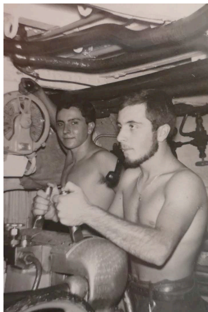
Fig. 152- Personale al posto di manovra sul pulpito di un motore MS407 sulle corvette classe APE negli anni '60. Spesso la rapidità e la frequenza delle manovre di arresto, inversione ed avviamento davano luogo a vere e proprie gare di abilità tra il personale dei due motori affiancati Le condizioni di vita a bordo non erano certamente di grande conforto, e meno in macchina
