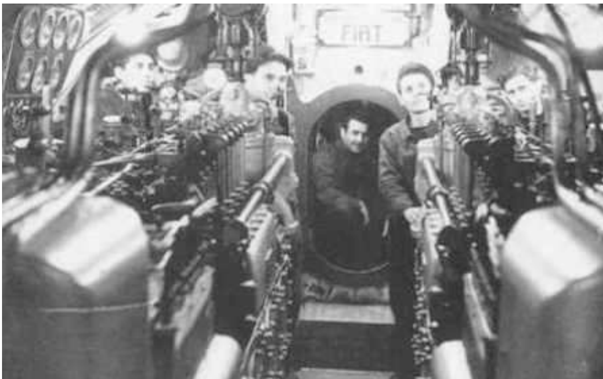
Fig. 150 - Personale al posto di manovra sul GIADA, serie Platino, vista verso pp Motori FIAT MS 407- (USMM) Non molta differenza tra le soluzioni per le corvette AS ed i sommergibili
