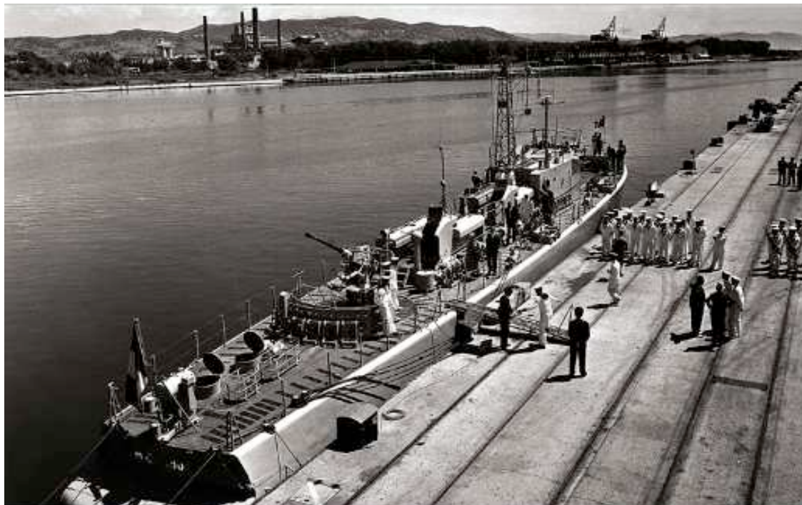
Fig. 208 - La MC 490, considerata a grandi linee una evoluzione del progetto S38 tedesco della 2 a GM, nella configurazione originale, al momento della consegna alla MMI, a Monfalcone, nell' agosto 1955. Notare il gradino poppiero dello scafo a livello di galleggiamento, poi eliminato in sede di grandi lavori (foto collez. autore)
