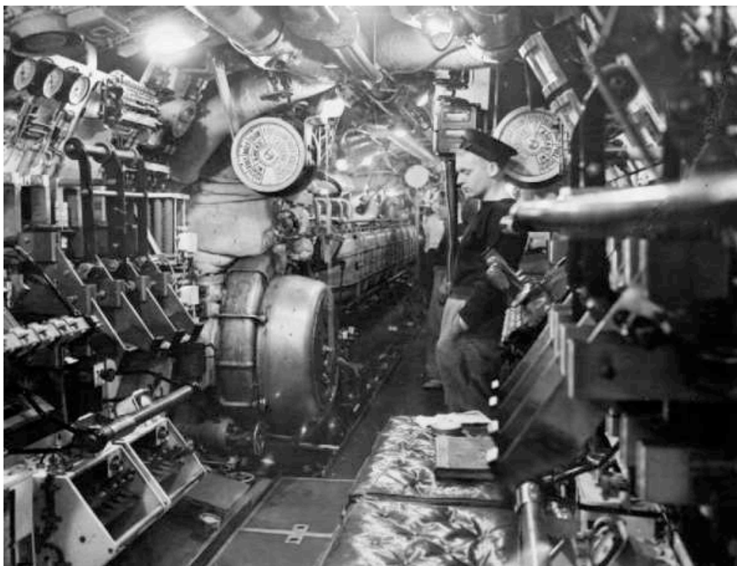
Fig.241 - Apparato Motore HMS Tribune con Motori MAN sovralimentati da 1250 HP montati in Inghilterra da Scotts
