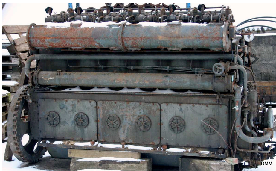
Fig. 192 - Motore Deutz MWM RS 34 S. 1940, recuperato dalla demolizione di un Type XXIII conservato in Danimarca, in attesa di musealizzazione
