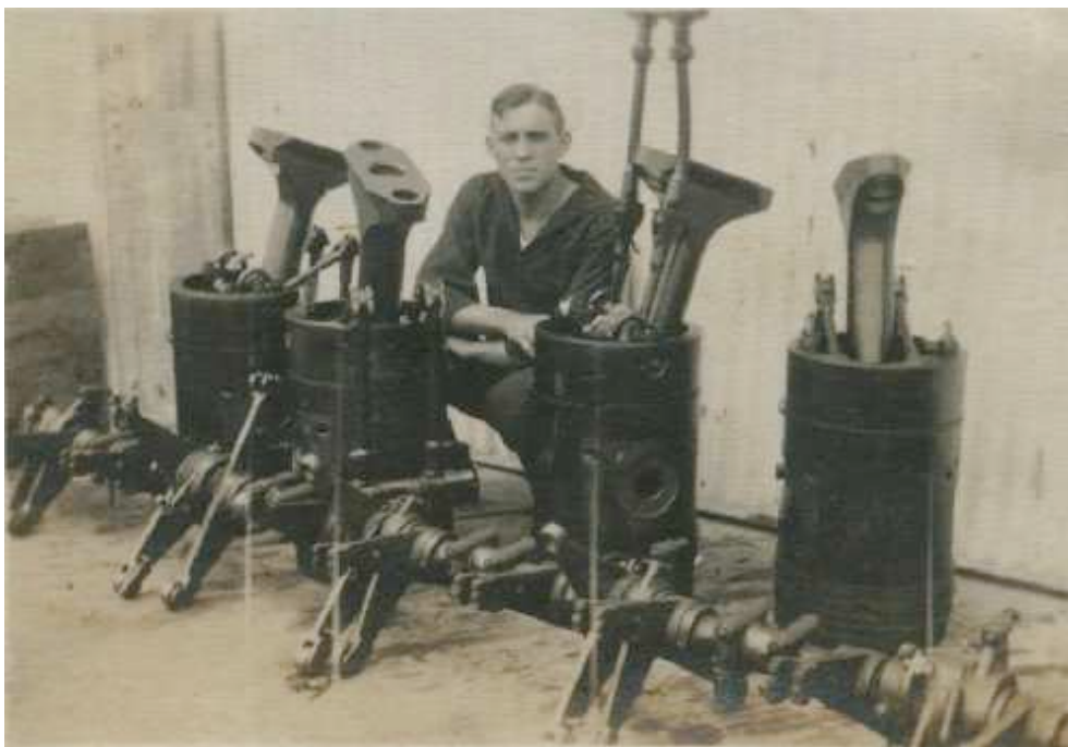
Fig. 226 -I componenti elementari dei motori del UB-88 smontati per ispezione nell' aprile del 1920, prima dell'affondamento in ottemperanza alle clausole del trattato di pace. È evidente il lavoro capillare di smontaggio e la meticolosità delle ispezioni con il rilievo di ogni dato, sia di stato che dimensionale, che permise al BuEng della US Navy di clonare letteralmente i motori, per la produzione che dovette assumere a seguito di una lunga contesa con la NELSECO (che porto anche alla scomparsa di questo costruttore)
