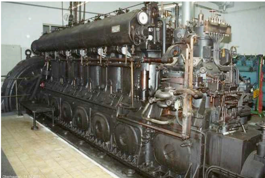
Fig. 224 - Motore MAN S6V 45/42, di costruzione 1918, uno degli esemplari studiati e clonati dal BuEng della US Navy
