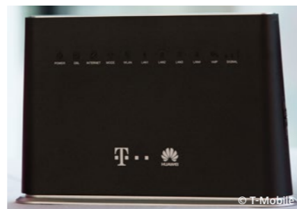
Der HomeNet Hybrid-Router kombiniert LTE mit DSL: Während die Grundlast über DSL abgeführt wird, sollen die Spitzen per LTE abgefangen werden.
