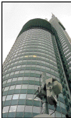
Una de las unidades receptoras de la red en la banda de 26GHz, en Viena.
