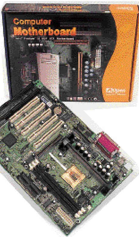
Si disponemos de una de las antiguas placas LX, puede ser interesante adquirir un convertidor a Socket 370 e instalar alguno de los últimos procesadores Celeron PPGA.
