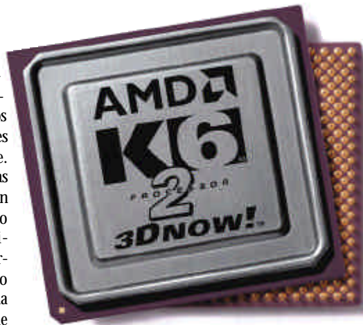
Una de las posibles opciones a la hora de actualizar el procesador de equipos con Socket 7 pasa por encontrar un procesador K6-2 que se adapte a nuestras necesidades y requerimientos.
