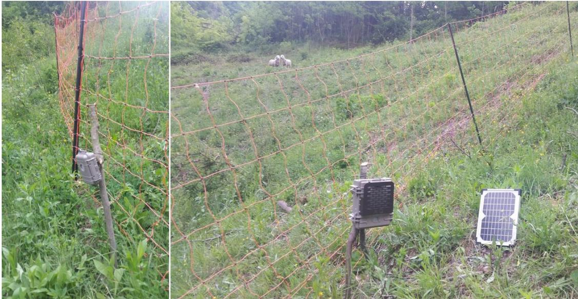
**Figura 9.4: Sistema congiunto di recinzione elettrificata e dissuasori acustici. A sinistra è raffigurato il sensore di attivazione, a destra il dispositivo di emissione del segnale alimentato con un pannello solare (T. Borghetti - Archivio Servizio Foreste e fauna PAT)**
