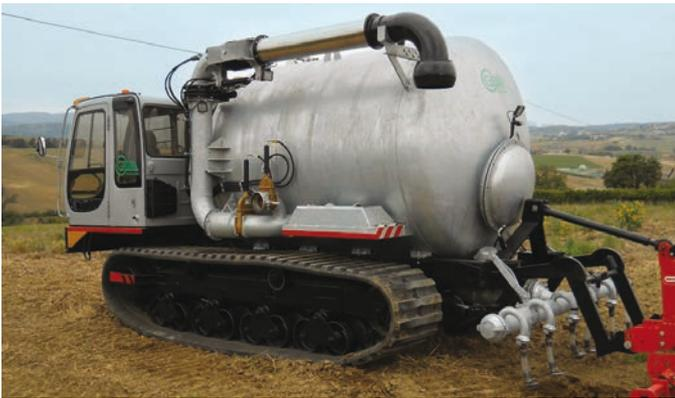
Le metodologie di spandimento a calpestamento minimo sono possibili grazie all'utilizzo di attrezzature su ruote a bassa pressione o comunque sprovviste di botte pesante. Altrimenti, tra le soluzioni messe a disposizione dalla tecnologia, anche macchine semoventi di recente sviluppo come quelle con movimentazione a cingoli.
