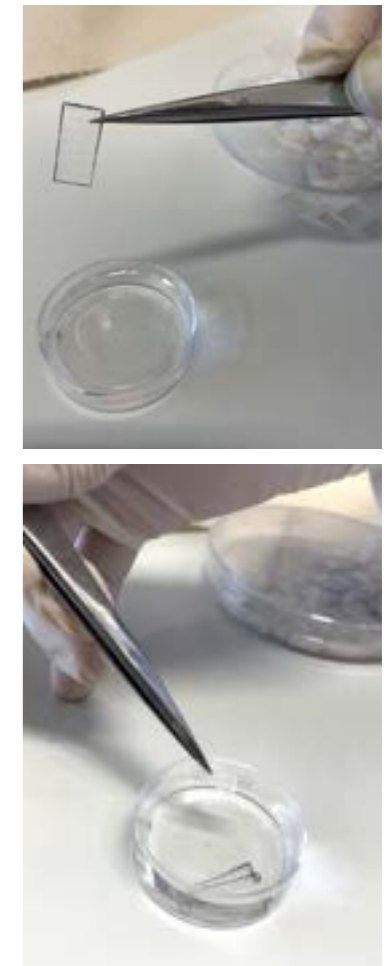
FIG. 12-13 Stampa 4D (Bioprinting&Biofabrication Group_Centro "E.Piaggio" Pisa). Reazione di swelling di costrutti igromorfici biostampati in una soluzione di PBS. I materiali utilizzati sono un gel idrofilo con 15% v/w di gelatina e 92 microlitri di GPTMS; un gel idrofobico con 5% v/w di gelatina e 368 microlitri di GPTMS. Il GPTMS agisce come cross-linker, poiché rafforza i legami della gelatina a 40°.
