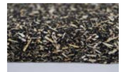
FIG. 23 Rethinking Materials, Ecopneus & Matrec, 2019. Il materiale a base di gomma riciclata viene miscelato o poliaccoppiato con numerosi materiali, sia di origine naturale che sintetica, anch'essi derivanti da riciclo, come: trucioli di legno, sughero, muschio, trucioli di plastica, ecc., a conferire proprietà uniche per ciascun tipo.
