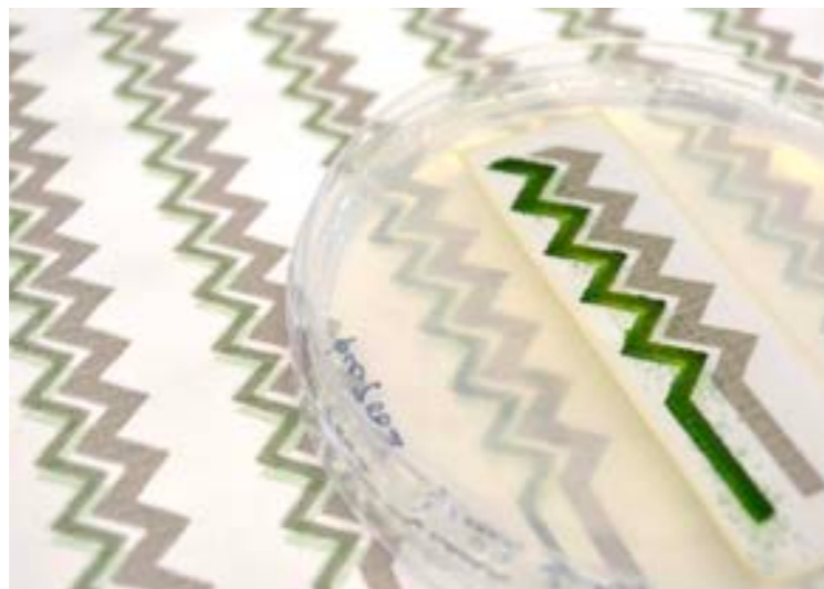
FIG. 12 Printable BPV: Electrogenesis wall-paper (2017). La designer inglese Marin Sawa, in collaborazione con un team di scienziati presso l'Imperial College di Londra, ha prodotto un prototipo di biobatteria e pannello biofotovoltaico insieme, grazie alla stampa a getto di inchiostro di cianobatteri (in grado di produrre energia grazie a fotopigmenti, come la clorofilla) e pigmento conduttivo, disposti e stampati secondo pattern modellati digitalmente.
