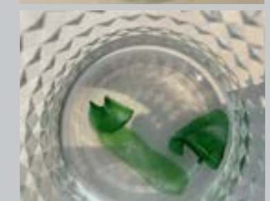
FIG. 8 (in alto) Prove di degradazione di composto a base di chitosano (6% v/w). Entrambe le foto sono state scattate dopo un'ora dall'immersione. Nell'immagine sopra, il materiale è stato immerso in una soluzione acida (1% v/w acido acetico) ed è quasi del tutto dissolto, anche se ci vorrà un'altra ora per scomparire. Nell'immagine in basso, il materiale è stato immerso in acqua e ci vorranno altre 11 ore per degradarsi. È interessante notare le proprietà di swelling del materiale in soluzione liquida, che può essere una caratteristica da applicare a successivi prodotti, utilizzando le potenzialità della stampa 4D e dei materiali igroscopici. (al lato) Alcune prove di biostampa di pattern 2D con gel comune (in alto) e chitosano (in basso). In quest'ultimo caso lo stesso materiale è stato tinto con coloranti alimentari per poter testare il funzionamento della modalità mixing del sistema robotico progettato
