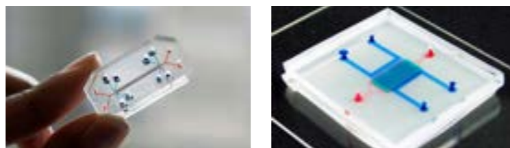
FIG. 7 Organs-on-Chips, Wiss Institute (Harvard University). A sinistra Lung-on-a-Chip, modello in vitro di un polmone artificiale (2015); a destra Heart-on-a-Chip, modello in vitro del cuore (2016).
