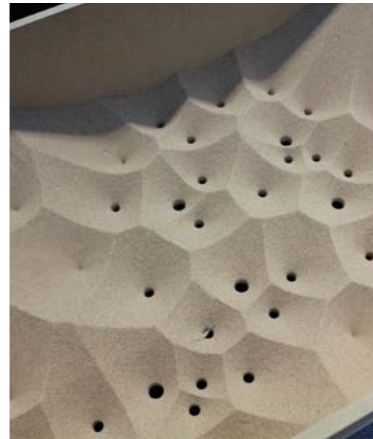
FIG. 14 Frei Otto, Sand Experiment Atelier Warmbronn, 1970. L'architetto è conosciuto per i suoi esperimenti attraverso i quali sperimentava i fenomeni della natura prima di applicarli all'architettura. Una modalità definita "analog digital" in cui un pensiero computazionale è applicato ad esperimenti materiali. Nell'immagine, lo studio della Tassellazione Voronoi eseguito facendo scorrere la sabbia in alcuni fori.
