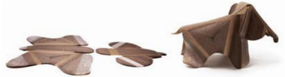
FIG. 14 Printed Wood Eames Elephant, Self Assembly Lab (MIT), 2014. Progetto dimostrativo, frutto delle numerose ricerche che i progettisti dell'MIT hanno svolto nel campo dei materiali igroscopici stampati in 3D. Sono chiaramente visibili parti più chiare, corrispondenti alle aree ricoperte di filamento polimerico (idrofobico) e parti più scure, dove è stato stampato filamento a base di legno (idrofilo). Come nella pigna, l'alternanza di strati idrofili e idrofobici permette alla struttura piana di piegarsi in presenza di umidità e calore assumendo la specifica conformazione del famoso elefantino di Charles Eames.
