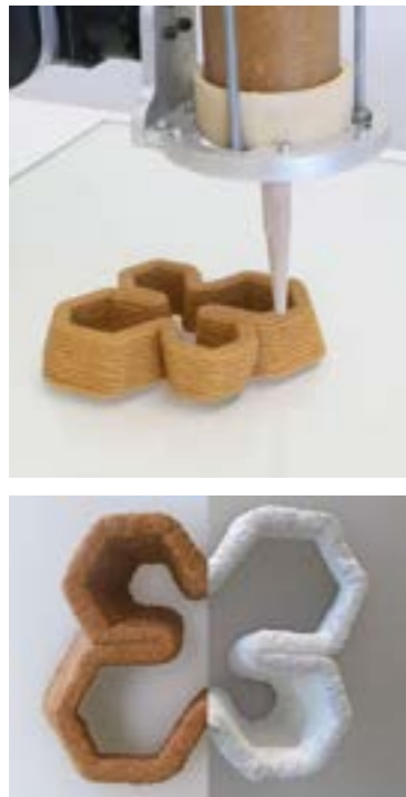
FIG. 38 Bio-ex-Machina, Officina Corpuscoli & Co-de-it, 2016. Un braccio robotico, dotato di un estrusore per paste a spinta pneumatica, deposita una miscela di scarti organici e spore di fungo. Il componente stampato viene posizionato all'interno di un bioreattore con elevate condizioni di umidità fino a quando non viene ricoperto totalmente dal micelio, trasformandosi in una struttura leggera e resistente.
