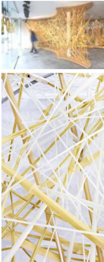
FIG. 18 LifeObject, Padiglione Israele Biennale Architettura Venezia, 2016. Le installazioni sono caratterizzate da aste in alluminio ricoperte da tessuto elastico le cui proprietà strutturali variano a seconda del tessuto e della tipologia di intreccio utilizzati.
