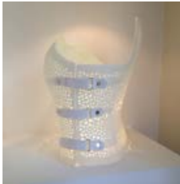
FIG. 16 Busti ortopedici realizzati dall'azienda Wasp, specializzata in stampa 3D. Nell'immagine è visibile la texture traspirante che varia la dimensione dei fori in corrispondenza delle aree che necessitano più o meno solidità strutturale.
