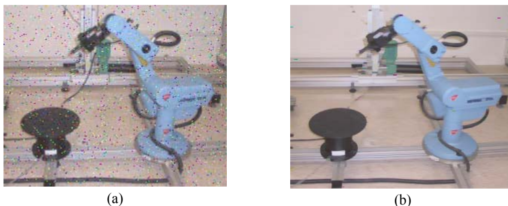
Figura 4.64. Eliminación de ruido impulsivo con filtrado alterno secuencial vectorial de tamaño 2. (a) Imagen cromática con ruido impulsivo (10%). (b) Filtrado FAS_v de tamaño 2 y patrón \gamma_v \phi_v .
