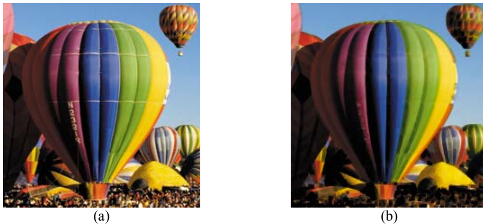
Figura 4.11. Erosión de una imagen en color mediante procesamiento marginal de canales RGB. Elemento estructurante de tamaño 3 \times 3 . (a) Imagen original. (b) Imagen erosionada.
