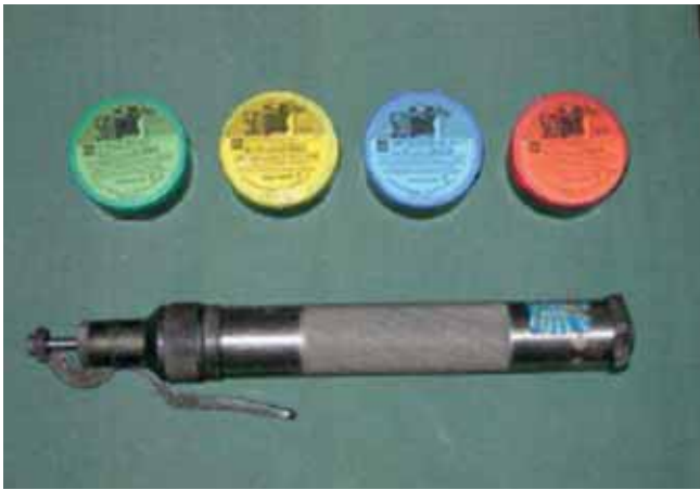
Figura 1 - Pistola a proiettile captivo e confezioni di diversi tipi di proiettili utilizzati (verde per gli ovini).
