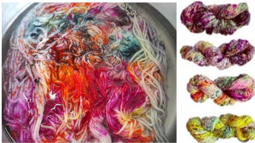
Figura 19. Lanas en los envases donde son teñidas y madejas multicolores, productos de este proceso. Elaboración propia
