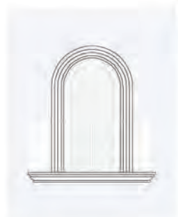
Portafinestra arcuata con cornice strombata
