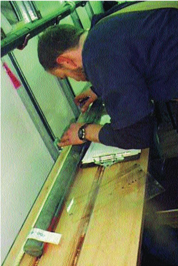
**Fig. 11** - Una fase di studio iniziale delle carote di sedimenti glacio-marini presso il sito di perforazione del Progetto Capo Roberts. È ripreso un geologo strutturale mentre analizza la disposizione dei sistemi di fratture per ottenere informazioni sulla storia della deformazione nel bacino sedimentario.
