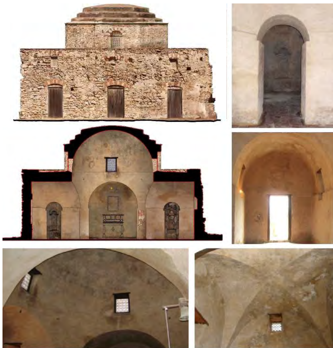
Figura 3. Il prospetto orientale e le caratteristiche architettoniche della chiesa.
