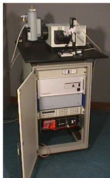
Fig. 1 – Vista parziale del MIR. Si notano il sistema goniometrico, lo spettrografo e il rivelatore CCD del primo sottosistema. Coperti dal monocromatore il laser e il sistema goniometrico per il riferimento dimensionale. Il secondo sottosistema e i proiettori per l'illuminazione sono installati separatamente.
