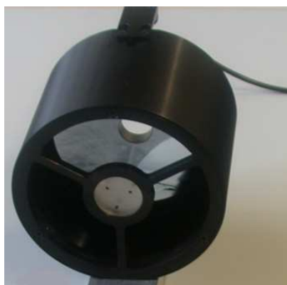
Fig. 2 – Montaggio meccanico dell'ottica di osservazione. Si distinguono lo specchio primario con il foro al centro e quello secondario più piccolo in primo piano.
