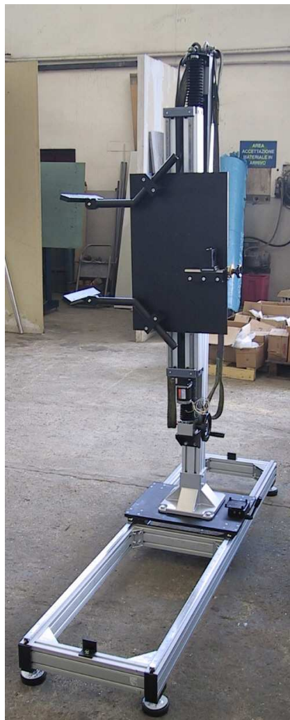
Fig. 5 – Evidenza della struttura a supporto della movimentazione orizzontale
