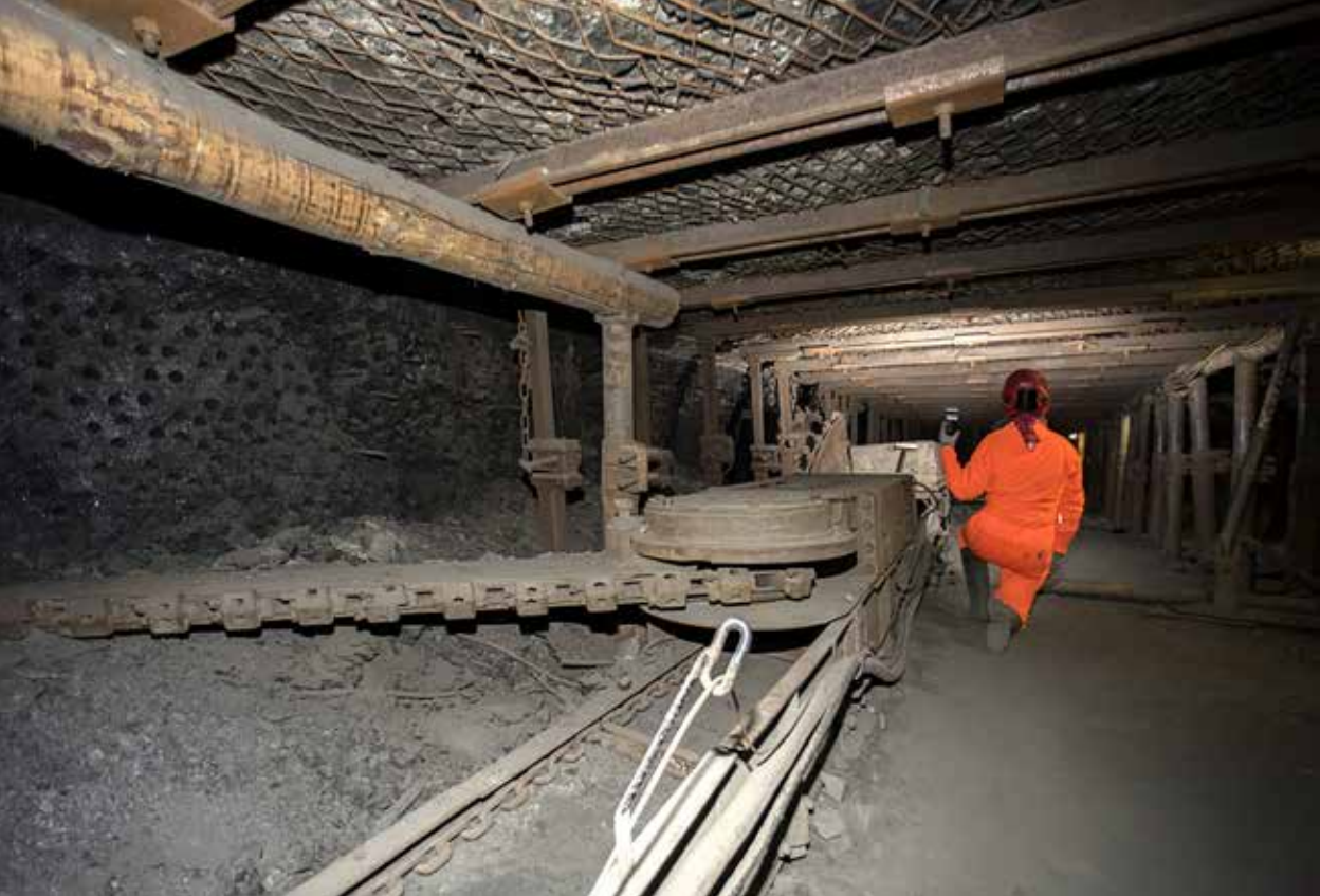
Kopalnia Guido: fresa lungo la taglia del carbone. (foto G. Belvederi).
