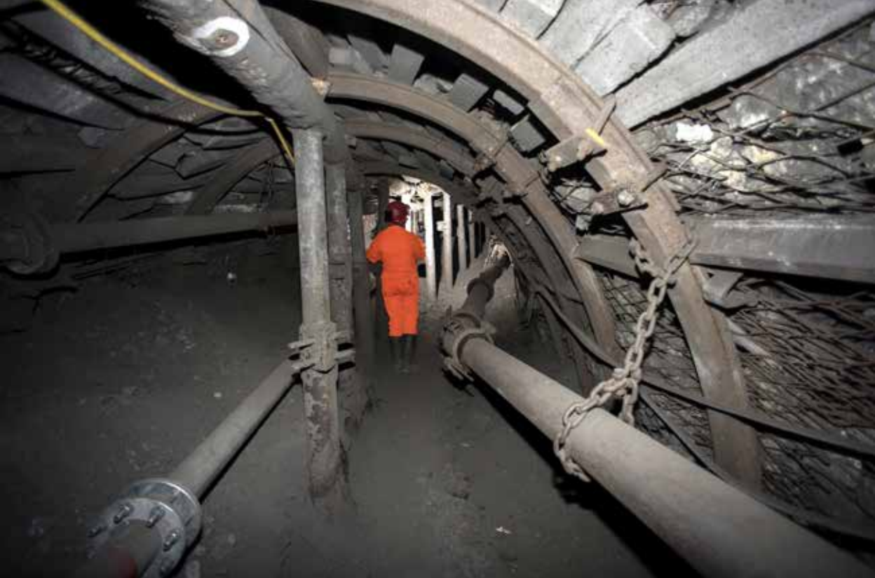
Kopalnia Guido: galleria con tubazioni per acqua e aria compressa. (foto G. Belvederi).
