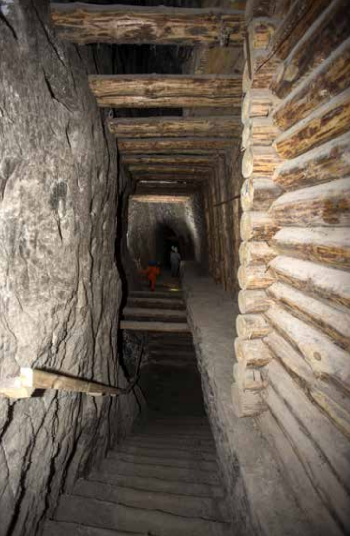
Kopalnia Bochnia: camera Stanetti II, profonda camera di coltivazione, che segue la forma del giacimento. (foto G. Belvederi).
