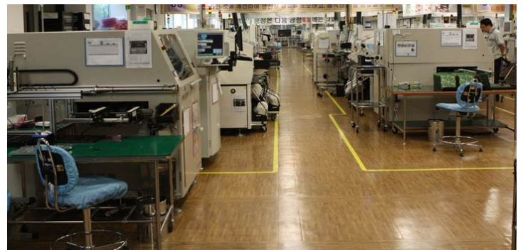
Figura 6 - Líneas de fabricación, donde las PCBs son trasladadas a otra máquina de soldadura para añadirle diferentes conectores tras el proceso de análisis, y pasar por todas las pruebas de funcionalidad.
