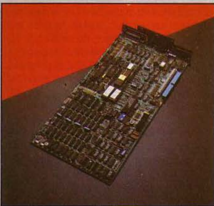
Le F1 est constitué d'une monocrate qui occupe la totalité du coffret. Il possède un connecteur d'extension interne unique pour carte additionnelle, et un accès au bus pour extension externe.
