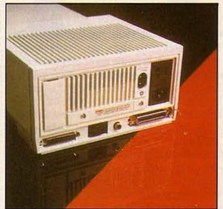
L'arrière du F1 offre les connecteurs parallèles et série, la sortie pour le moniteur et une sortie vidéo.
