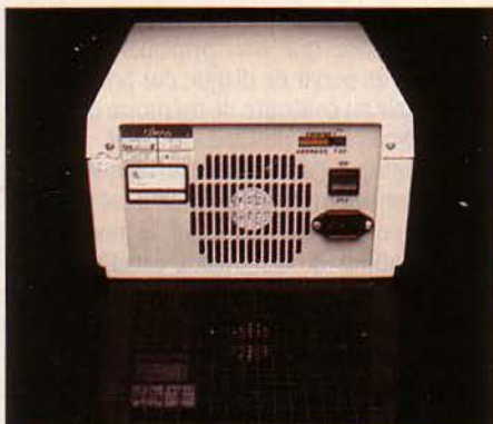
Le disque Corvus est prévu pour s'intégrer dans un réseau local de Macintosh, de type Omninet.
