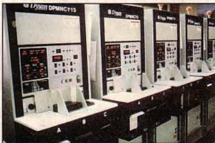
Machine pratiquant le formatage des disquettes, c'est-à-dire la découpe des pistes en secteurs où l'on pourra "ranger" les informations à mémoriser.
