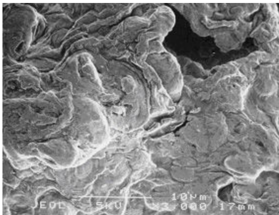
Figura 1.6: superficie di un grano di polvere PM100 a 3000 ingrandimenti.
