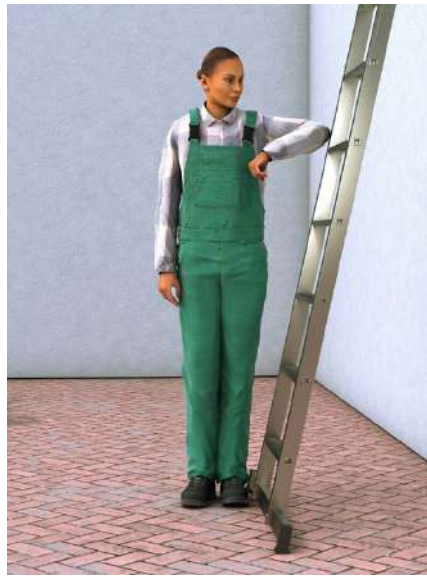
Fig. 59 „Méthode du coude“ pour déterminer l'angle d'application
