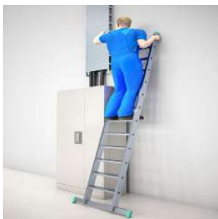
Abb. 58 Sicherer Stand auf einer Stufenanlegeleiter
