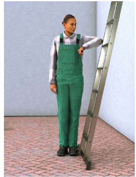
Fig. 59 „Metodo del gomito“ per determinare l'angolo di applicazione
