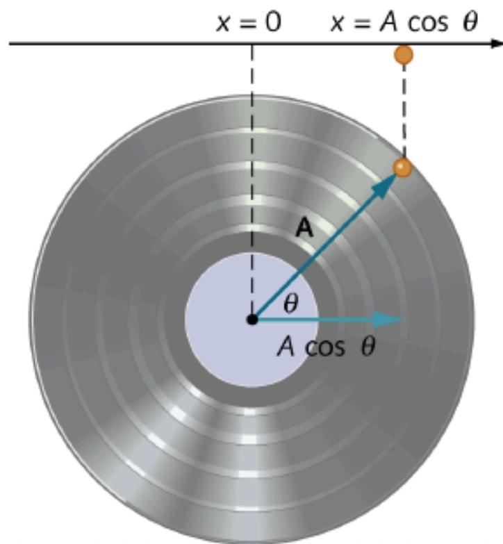
Il disco (e ogni suo punto) ruota con moto circolare uniforme e velocità angolare  $\omega$
