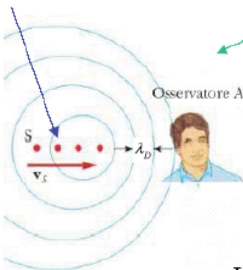
**Sorgente in moto** con velocità  $v_s$  verso l'osservatore : in un periodo di oscillazione  $T$ , i fronti d'onda vengono “schiacciati” perché il massimo successivo si presenta con  $\lambda = v_s \cdot T = v_s / \nu$ . La lunghezza d'onda percepita dall'osservatore è quindi diminuita di:
