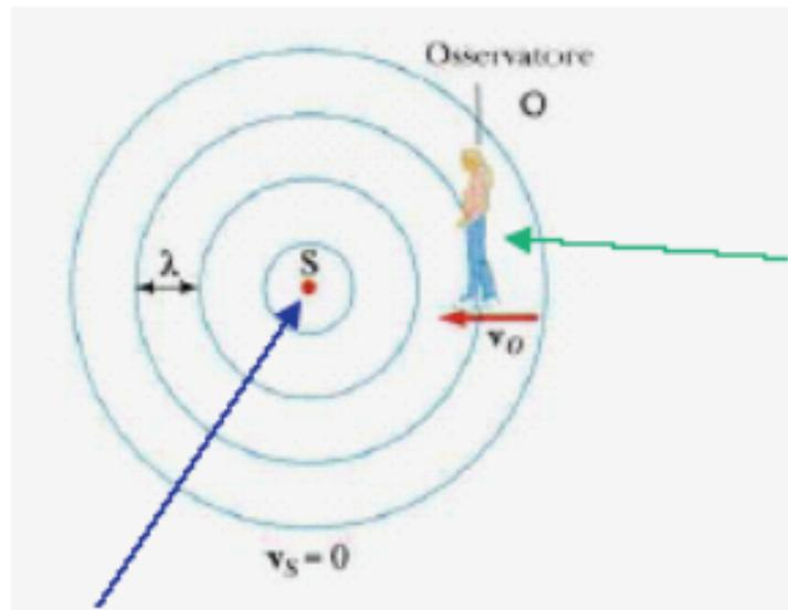
Sorgente che emette un'onda sonora di velocità  $v$  che si propaga nello spazio come onda sferica; le linee sono le creste dell'onda
