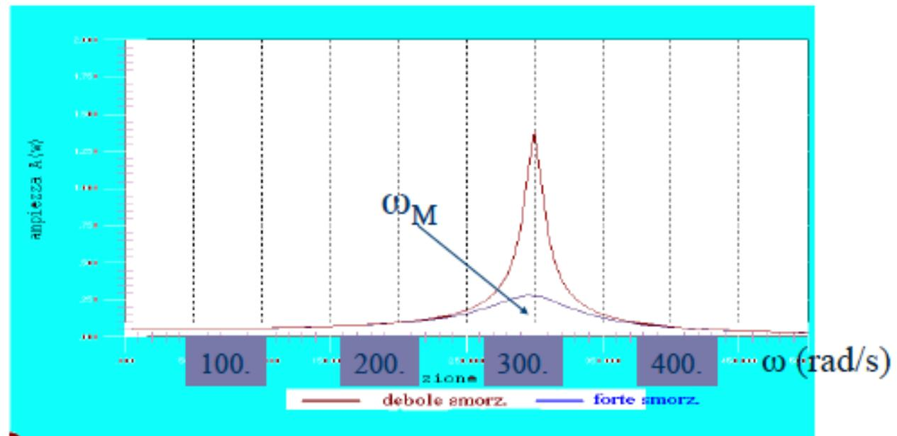
Massimo della ampiezza di oscillazione:  $\omega_M = \sqrt{\omega_0^2 - 2\gamma^2}$
