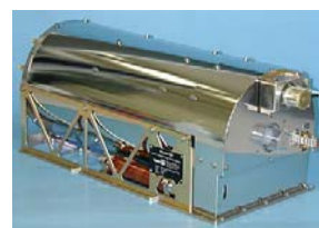
Orologio a Idrogeno per satelliti GALILEO
