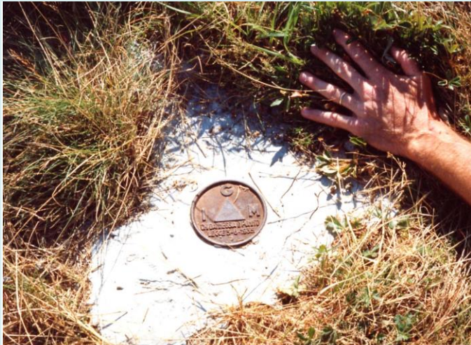
Materializzazione di un Punto trigonometrico sul terreno
